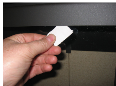
Bild 5 Rengöring av luftspalt
